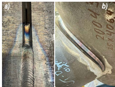
a) cső tömpavarratának többsoros hegesztése 3-4 mm-es gyökhézag estén b) csövek áthatásának gyökvarrata
